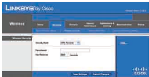
Security Mode > WPA Personal (Modalità di protezione > WPA-Personal)
